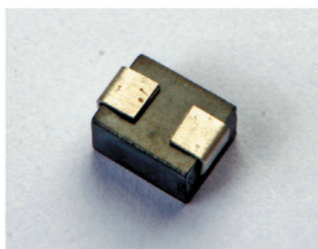
Рисунок 2 - Внешний вид фильтров ФЭМИ-2
