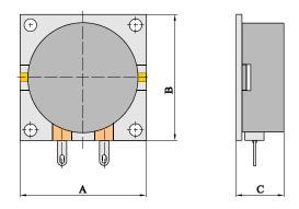
Полосно-пропускающие перестраиваемые фильтры на ЖИГ-резонаторах с микрополосковыми выводами.
