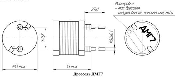
Дроссели на основе ферритовых сердечников гантельного типа предназначены для работы в электронной аппаратуре в качестве накопительных дросселей, а также в составе помехоподавляющих фильтров.
